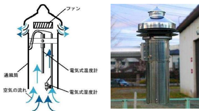
図 6.4 気温センサーを入れる通風筒の例（断面と外観） 152
